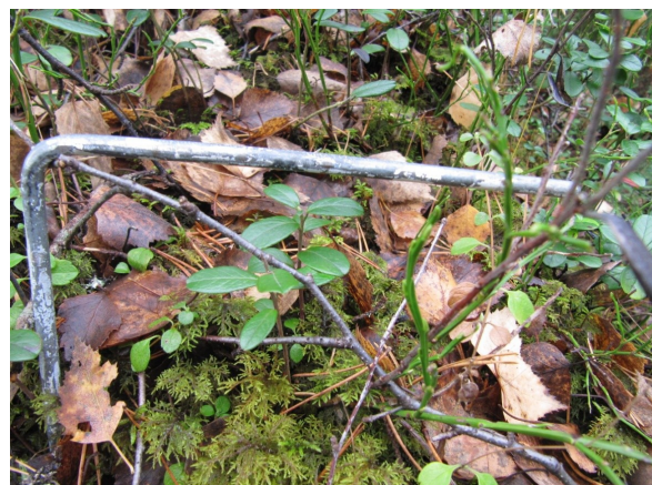
Figur 1 Vinkelrett stålstang stikkes i bakken. Den snures rundt for å måle opp undersøkelsesområdet. Radius = 17,8 cm (kilde: Høgskolen i Hedmark).
